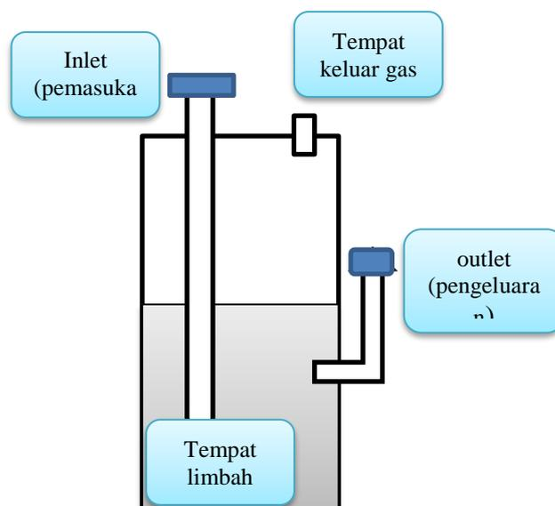
Gambar 4.1 Rancangan desain digester biogas mini
